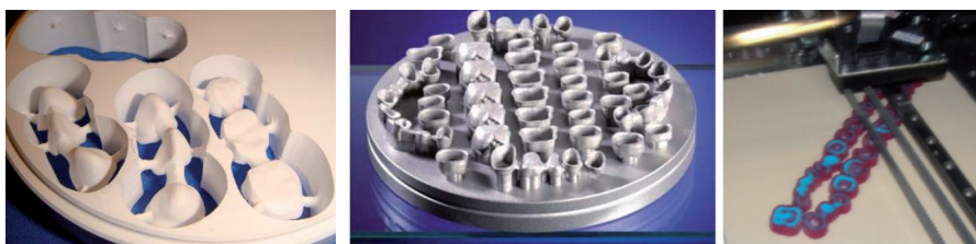
Fig.5: Restauraciones dentales. A: por sustracción de material. B: por sinterizado selectivo por láser de una aleación en polvo. C: prototipado rápido
