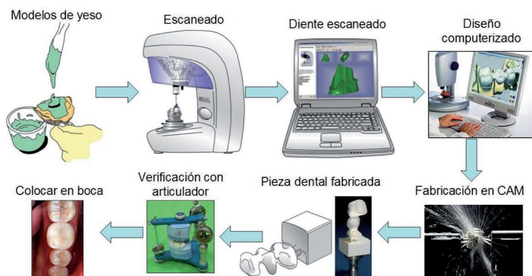
Fig. 1: Proceso en un sistema CAD/CAM dental general
